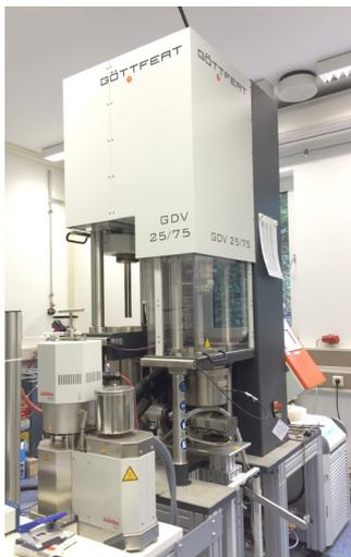
Das Hochdruckkapillarrheometer ist eine Sonderanfertigung der Firma GÖTTFERT
