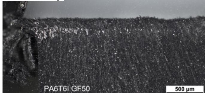
Lichtmikroskopische Aufnahme einer Schweißnaht aus vernetztem PA66 mit PA6T/6I GF50 (Aufnahmebedingungen: Dunkel-feld), Festigkeit 81,4 N/mm<sup>2</sup>
