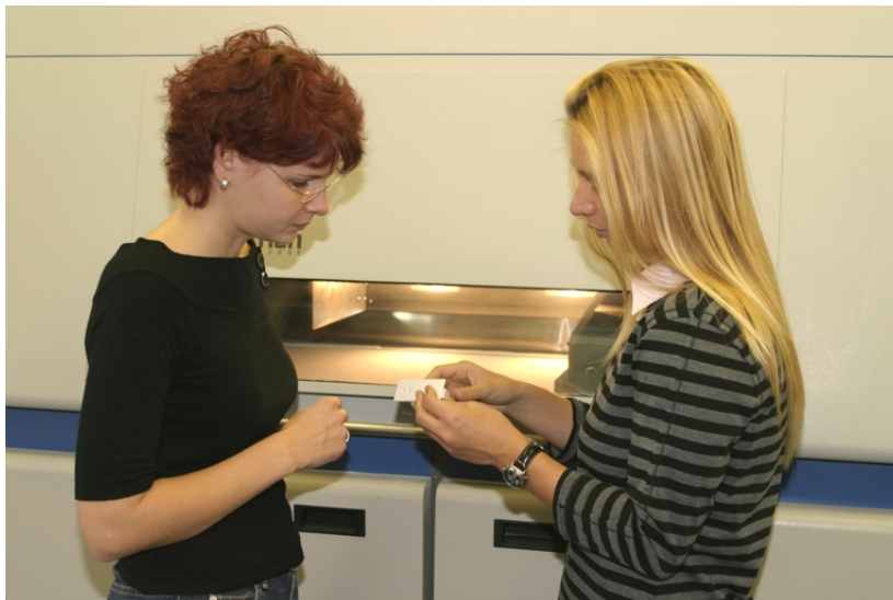
Bild 1: Lasersinteranlage DTM 2000 (Sichtfenster Bauraum)
