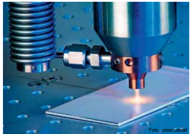
Plasmapolymerbeschichtung eines Aluminiumbleches
