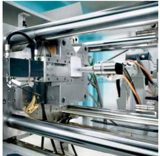
Open-Air® Plasma-Düse, montiert auf 6-Achs-Roboter und eingefahren ins geöffnete Werkzeug
