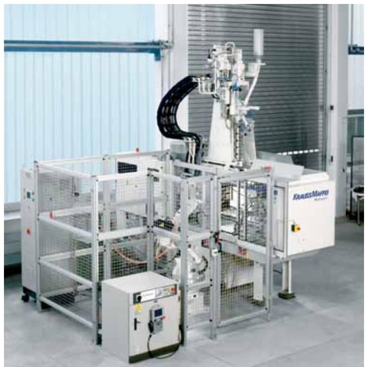
Open-Air® Plasma-Düse, montiert auf 6-Achs-Roboter und eingefahren ins geöffnete Werkzeug
